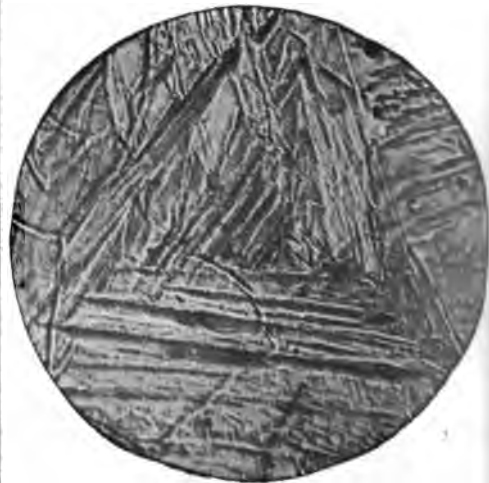
Fig. 64. Martensite. (Osmond and Cartaud, Annales des Mines , XIV, p. 62, 1900; The Metallographist , IV, p. 236, et seq. )
